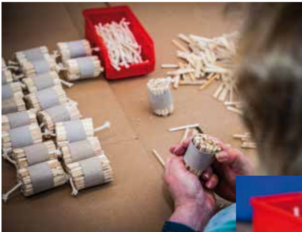
Grillanzünder-Produktion: Einfügen des Dochts
