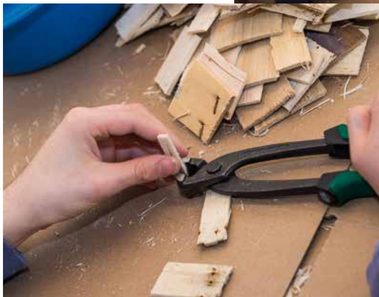
Grillanzünder-Produktion: Zerkleinern der Holzbrettchen
