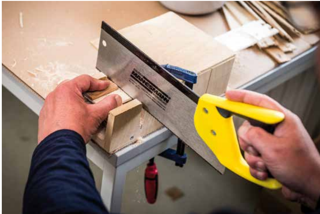
Grillanzünder-Produktion: Ablängen der Holzbrettchen
