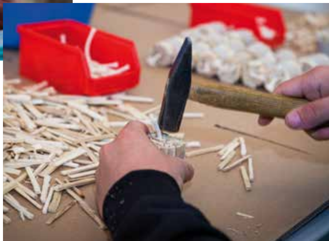
Grillanzünder-Produktion: Einfügen des Dochts
